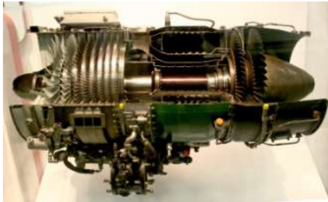
Motor com dois eixos e dois carretéis de compressor - GEJ85-5
