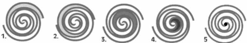
Figura 3.20 - Processo de compressão em um compressor Scroll
